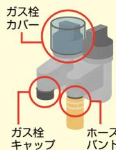
使わないガス栓にはガス栓カバー、ガス栓キャップをかぶせてください。ゴム管はガス栓の赤い線まできっちり差し込み、ホースバンドで留めてください。ガス栓キャップは、お使いにならないガス栓の口部に傷や汚れがつくことを防止するためのものであり、ガスを止めるために設置するものではありません。
