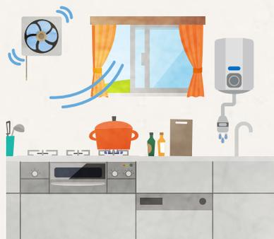
ガスの炎に限らず、火が燃えるためには新鮮な空気（酸素）が必要です。普段の環境でガスを燃やすと、生活に必要な“熱”が発生すると共に、二酸化炭素（CO<sub>2</sub>）が発生します。二酸化炭素（CO<sub>2</sub>）は炭酸飲料の成分でもあり、人の吐く息にも含まれているもので、基本的には問題ないものです。
